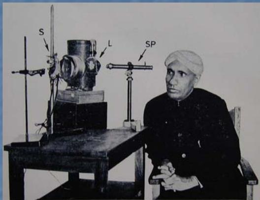
印度物理学家拉曼 (Raman) 从实验上观察到; 单色的光照射到液体苯时, 他发现在散射光中除了含与入射光相同频率的光外, 还有更多与入射光频率发生位移 (频移增加和减少) 且强度极弱的谱线。前者就是已知的瑞利散射。后者是新发现的, 是由分子振动所引起的散射。后来就以发现者拉曼的名字命名的拉曼散射光, 称为拉曼散射效应。为此, 拉曼获得1930年度的诺贝尔物理学奖。从拉曼光谱的研究, 可以得到有关分子振动或转动的信息。
