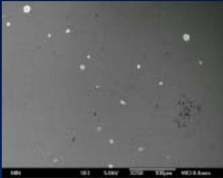
Fig.1. SEM观测到的 $\text{Al}_2\text{O}_3$ (3.5 nm) / AlGaIn表面，白色亮点为AlGaIn中缺陷
