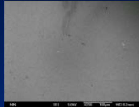
Fig.2. SEM观测到的 $\text{Al}_2\text{O}_3$ /Si表面，几乎没有缺陷
